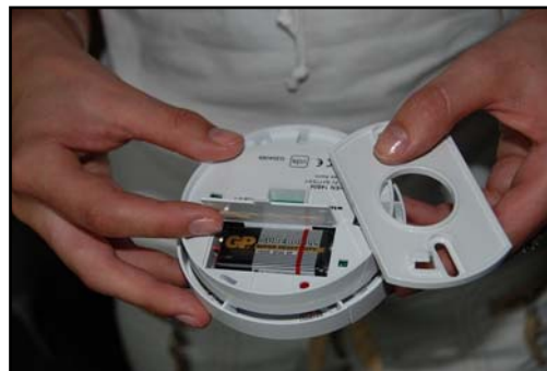
Obr. 4: Autonomní hlásič kouře (detail) – napájení baterií.
